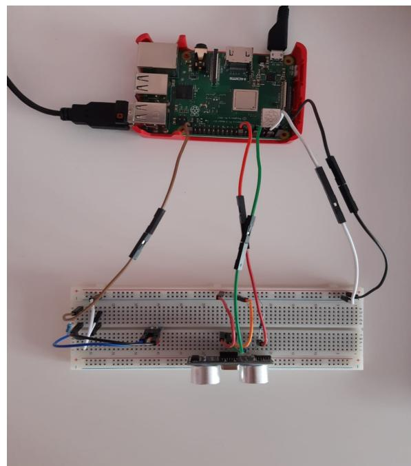
**Scopul acestui proiect este de a realiza un sistem de supraveghere prin care se detectează mișcarea. Dacă un obiect/persoană se află la o distanță minimă setată în program de senzor, atunci se va activa camera WebCam și va efectua o poză pe care ulterior o va trimite pe mail.**
